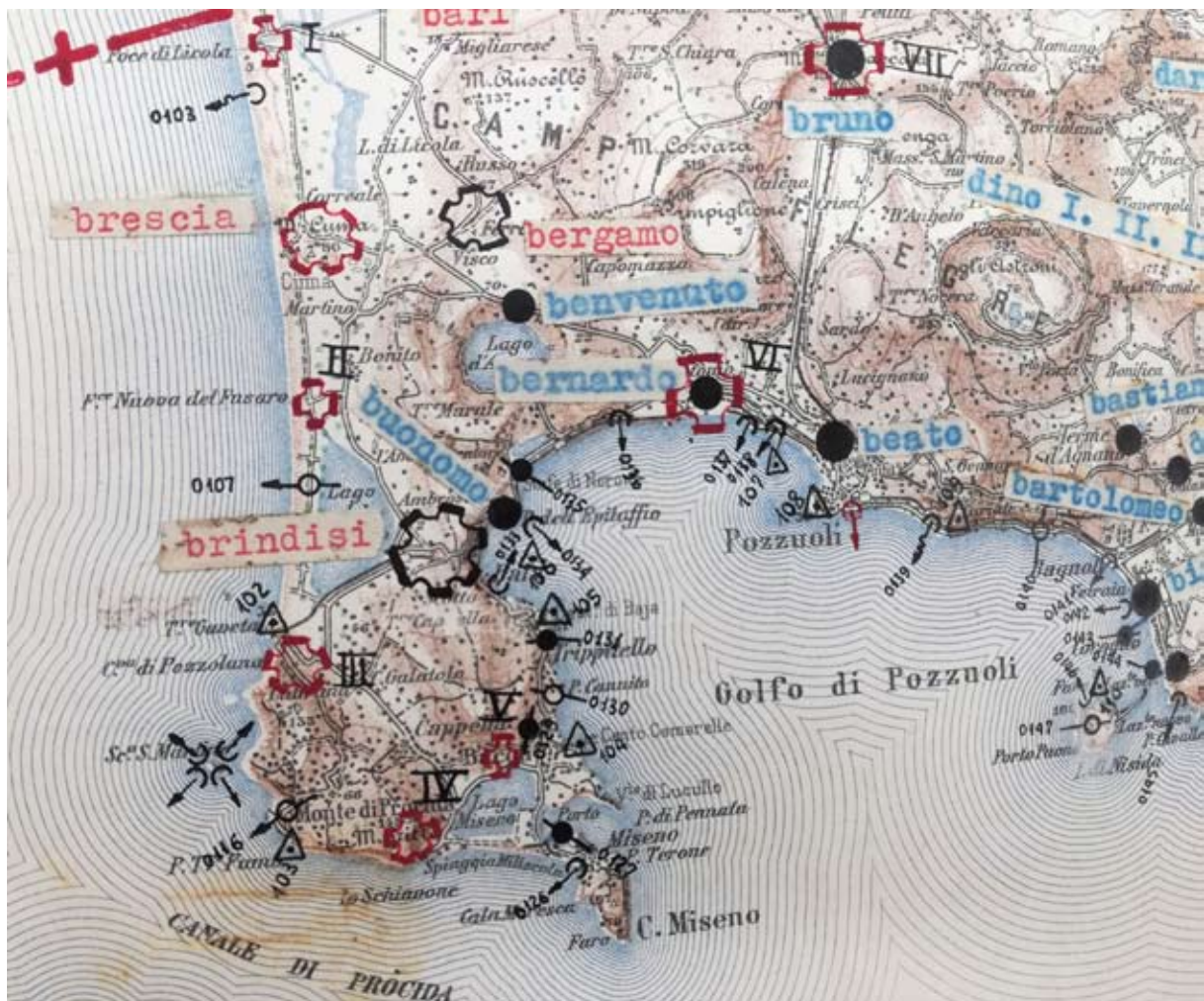
Fig. 1. Grafico dei lavori di fortificazione relativi al settore difesa del porto di Napoli nel mese di giugno: in nero i lavori ultimati; in rosso i lavori in corso di costruzione; in verde i lavori in progetto (da AUSSME, fondo L 12, busta 37, fasc. B).
