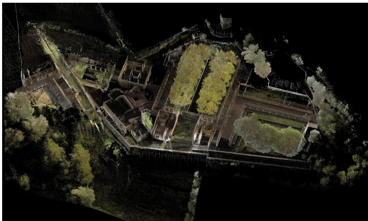
Fig. 6. Rilievo laser scanner di Villa San Marco - Castellammare di Stabia (elab. M. Silani).
