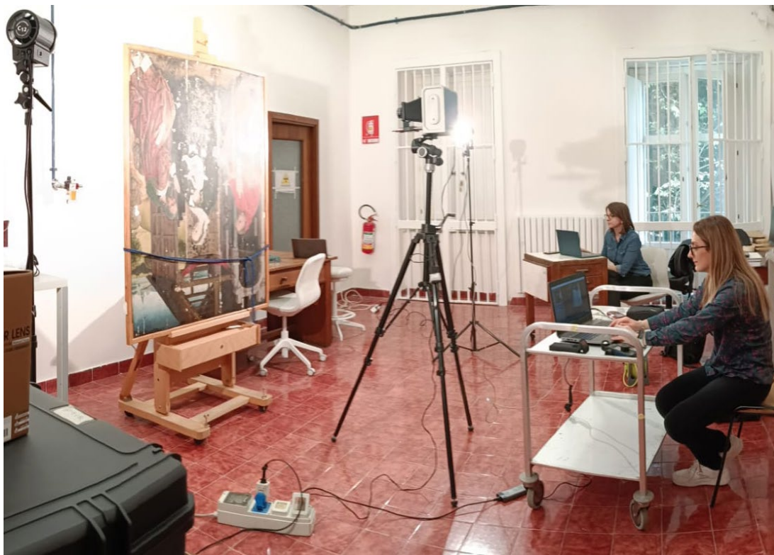
Fig. 7. Indagini in corso di esecuzione – riflettografia IR (1700 nm) – nell’Officina Capodimonte.
