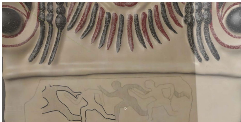
Fig. 5. Riproduzione dell'interfaccia texture di Blender durante la ricostruzione della texture di un'antefissa a maschera gorgonica e utilizzo della funzione stencil per ricostruire la decorazione del listello (riproduzione grafica KOCH 1912, elaborazione M. Esposito).
