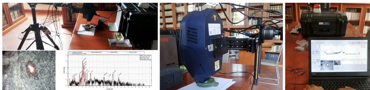
Fig. 2. Fasi di misurazione con spettrometro portatile ED-XRF, dettaglio dei punti di campionamento ed esempio dei report di analisi (elab. dell'autore).
